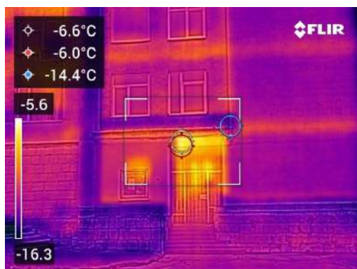
Рисунок 4. Инспекция холодных зон здания
