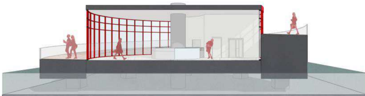
Figura 10. Secțiune cafenea pe apă [13]
