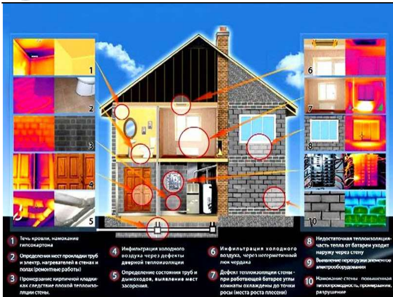
Рисунок 3. Теплотери здания, выявленные с помощью тепловизора
