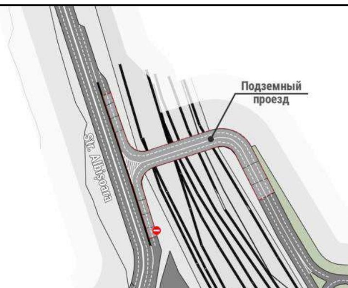
Рис. 6. Подземный автомобильный проезд соединяющий территорию ТПУ с центральными магистралями
