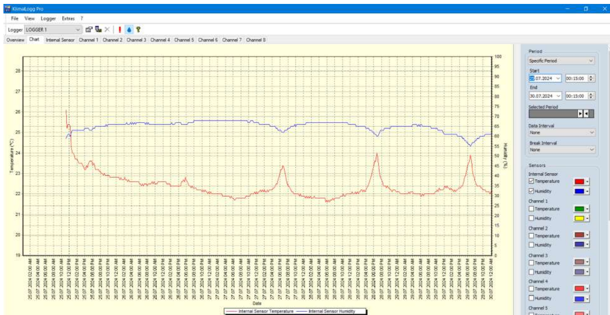
Figura 6. Graficul cu distribuția temperaturii și umidității aerului interior pentru luna iulie colectată cu termo-higrometrul tip data logger TFA
