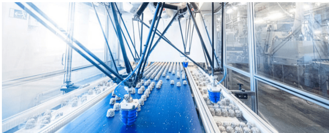
Figura 1. ABB IRB 360 FlexPicker utilizat pentru sortarea rapidă a produselor alimentare
