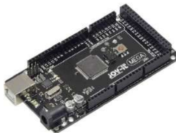
Figura 2. Placă de dezvoltare Joy-it compatibilă Arduino MEGA 2560R3
