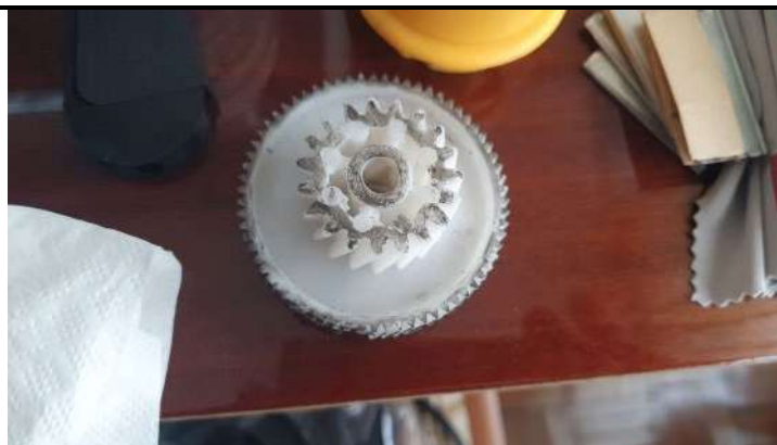
Fig 1 Roata dințată deteriorată
