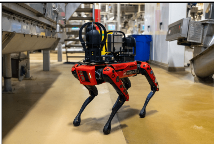
Figura 2. Robotul autonom Spot utilizat pentru inspecții în fabrica Nestlé Purina, [1]
