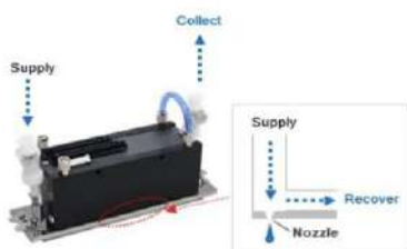
Figura 3. Tehnologie de recirculare a cernelii în jurul duzelor pentru modelul anului 2024 Kyocera KJ4B-EX1200-RC [7]
