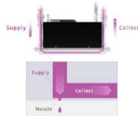
Figura 4. Tehnologie de recirculare a cernelii în jurul duzelor pentru modelul anului 2025 Kyocera KJ4A-EX1200-RC [8]
