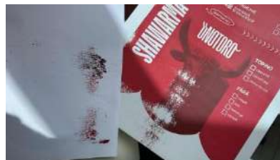
Рисунок 8. Отпечаток с дефектом, полученный при печати на цветном принтере HP LaserJet Professional CP5225n
