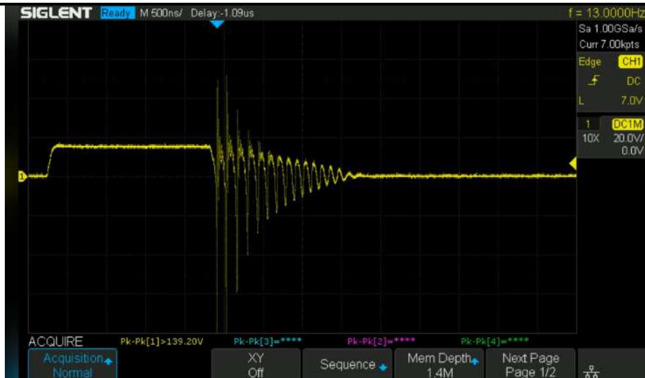
Figura 3. Imaginea unui semnal captat cu osciloscopul de pe grila unui mosfet de tip SIC
