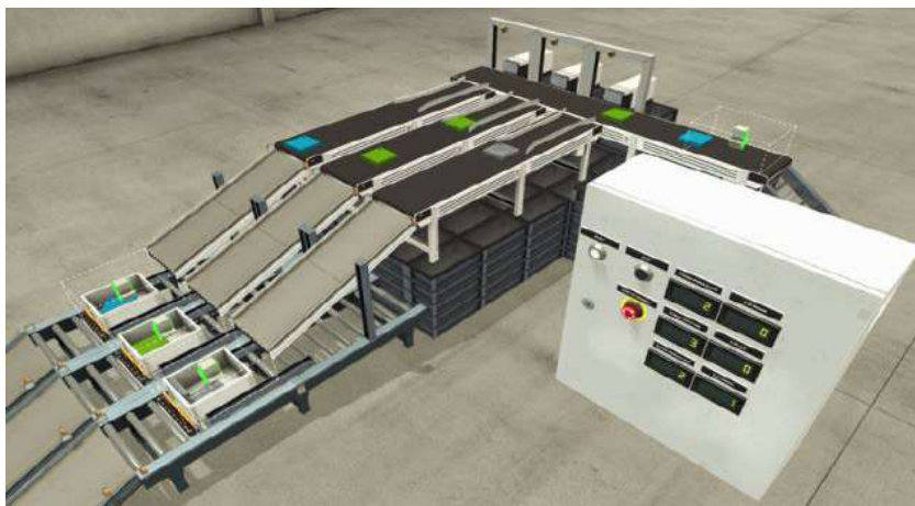
Figura 3.2. Modelul instalației automatizate realizată în Factory I/O
