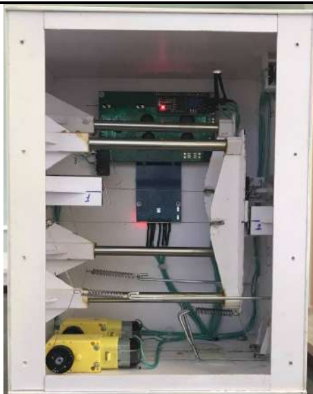
Figura 19: Mecanism intern al sistemului de blocare și deblocare al parcării
