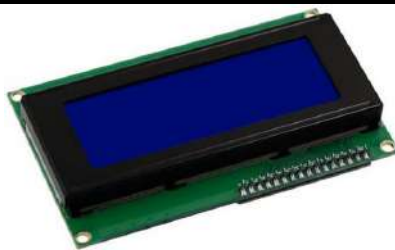
Figura 4: Ecran LCD 2004 cu I2C [4]
